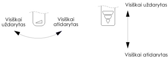
5 pav. Pavyzdinis oro padavimo į krosnį reguliavimas (peleninės fasado vaizdas).
