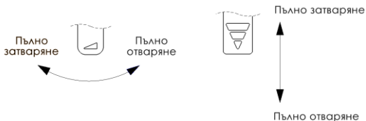
Фиг.5 Пример за настройка на подаването на въздух за горене
