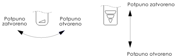
Crtež 5. Primjer regulacije dotoka zraka u ložište.
