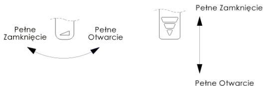
Rys.5. Przykładowa regulacja dopływu powietrza do paleniska
