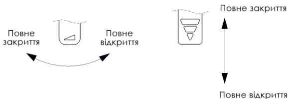
Рис. 5. Приклад регулювання подачі повітря в топку.
