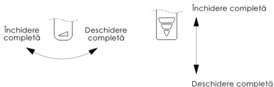
Fig. 5. Un exemplu de reglare a admisiei de aer proaspăt (fata sobei)
