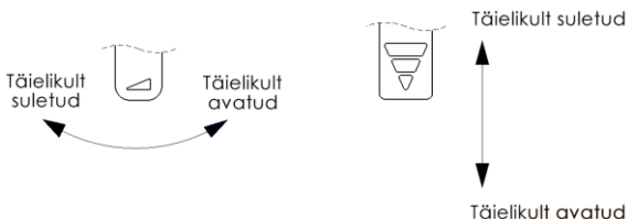
Joonis 5. Kamina õhuava reguleerimise näide (tuhaaluse esikülgl)
