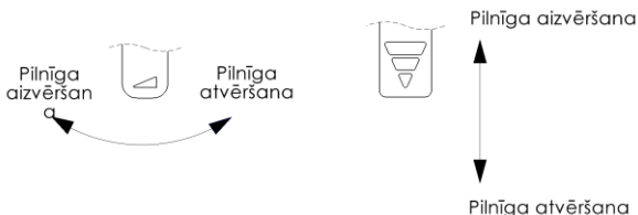
Att. 5 Krāsns gaisa padeves regulēšanas piemērs (skats no krāsns priekšpusēs).
